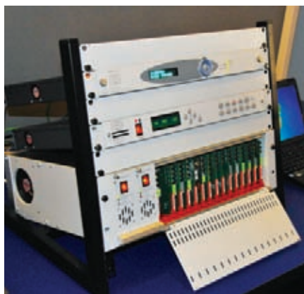
Оборудование «ПРОФИТТ» (сверху вниз): профессиональный декодер H.264/AVC PMPD-3610, SDI-видеомикшер PDMX 2007 и модульная система PROFLEX с открытой передней панелью
